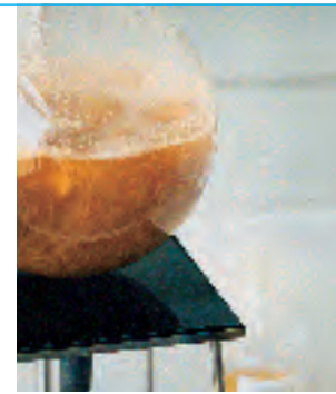
Anschließend werden die zerkleinerten Wurzelstücke in einer wässrig-alkoholischen Lösung ausgekocht (Decoct).
